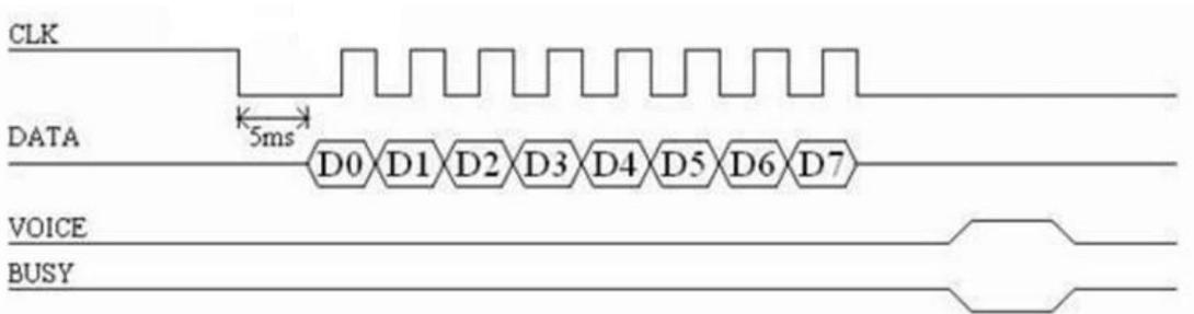
两线串口控制模式由片时钟 CLK 和数据 DATA 进行控制操作，每发一个字节数据，时钟信号 CLK 拉低 4ms 至 40ms，推荐使用 5ms 以唤醒 WTN7 语音芯片，接收数据低位在先，在时钟的上升沿接收数据。时钟周期介于 40us~3.2ms 之间，推荐高低电平持续时间各使用 300us（即一个 bit 发送的时钟周期为 600us）。发数据时先发低位，再发高位。数据中的 00H~CFH 为语音地址指令，E0H~EFH 为音量调节命令，F2H 为循环播放命令，FEH 为停止播放命令。
